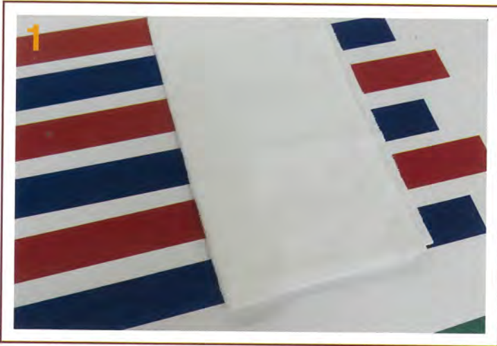
1.スキージーで押さえた後のEカルテントの上に当て布を置いていただき・・・
